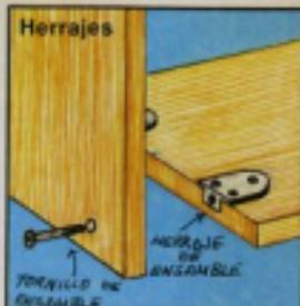
Se utilizan para ensamblar tableros. Marca el lugar donde vayas a colocarlo y taladra un agujero para el tornillo. Luego pasa el formón para alisar.
