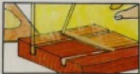
Espárcela la mezcla en una de las superficies, después sujétalas en la posición correcta hasta que seque.
