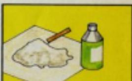
Puedes mezclar el relleno con cola blanca para hacer una pasta densa. Prueba primero en un trozo de madera.
