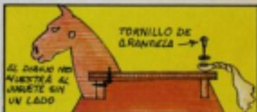
Ensambla la cabeza al asiento y taco con tornillos y cola. Encola el mango y trenza cuerda para la cola.
