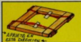
Ata el armazón con una cuerda. Para tensarla, introduce un taco entre las dos hebras y hazlo girar.
