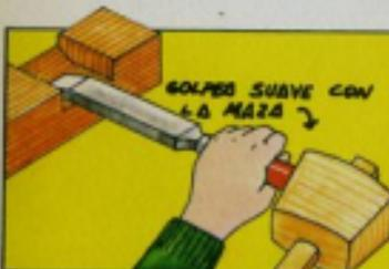
Para empujar el formón utiliza una maza. No utilices martillo porque puede romper el mango del formón. Si no tienes una maza, utiliza un taco de madera.
