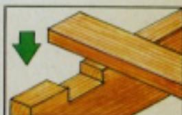
Prueba si encajan los ensamblajes, no empujes ni golpees las maderas.
