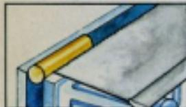
Sierra la ranura con la clavija fuertemente sujeta. Las clavijas sin ranura se pueden romper al clavarlas.
