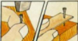
Empieza a clavar golpeando con la parte delgada del martillo, o empuja el clavo a través de un cartón.
