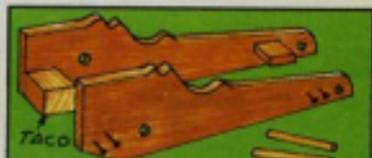
A continuación separa los laterales, clava y encola los tacos y ensambla los ejes y ruedas. Encola las ruedas de atrás.
