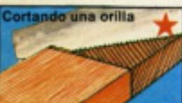
Para serrar un trozo de madera del tamaño exacto, corta siempre por fuera de la línea de señal.
