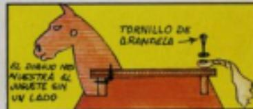
Ensambla la cabeza al asiento y tacó con tornillos y cola. Encola el mango y trenza cuerda para la cola.
