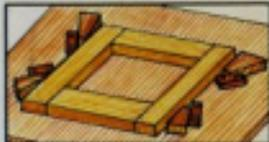
Otra forma de hacerlo consiste en clavar trozos de madera a una tabla, colocar el armazón entre ellos y acuarlar.
