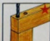
Cuida que la ensambladura no se parta cuando claves las clavijas.
