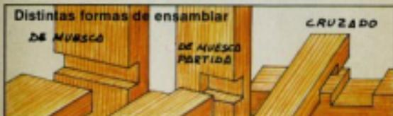
Para hacer estos ensamblajes se utiliza la misma técnica que para los ensamblajes de espiga.
