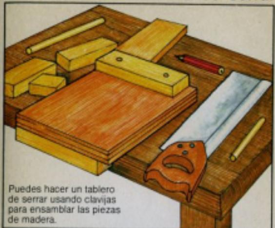
Puedes hacer un tablero de serrar usando clavijas para ensamblar las piezas de madera.
