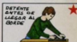
Mantén la misma presión al tiempo que cepillas hacia el otro borde. Comprueba la superficie.
