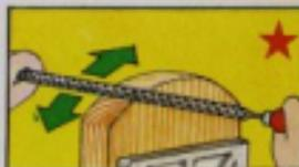
Utiliza una escofina en ángulo para raspar la madera, de esta manera no rasgará las fibras.
