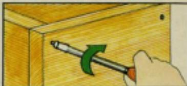
Introduce el destornillador en los agujeros de guía, empuja el destornillador y giralo al tiempo.
