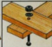
Atornilla el eje en la parte frontal de la pieza volante.
