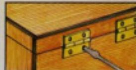
Coloca los primeros tornillos y comprueba si la caja encaja. Si los tornillos son demasiado largos, lima el sobrante.
