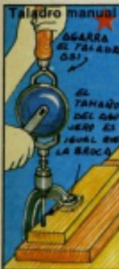
Sujeta la madera colocando debajo un trozo de madera cuando taladres.
