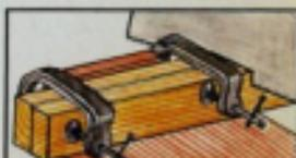
Para cortar las piezas de ambos armazones de la misma longitud, sujétalos con la agarradera al serrarlos.
