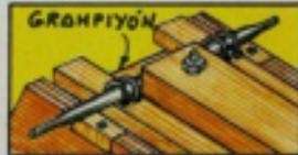
Atornilla o clava el eje trasero al respaldo del trineo y ajusta las ruedas a los ejes.
