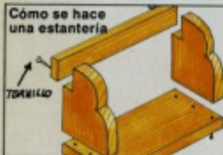
Haz el diseño en un papel. Después lo copias y pegas a la madera. Recorta la madera alrededor del dibujo con la sierra abrazadera, después ensambla la base con cola y clavos.
